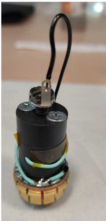
Figura2. Foto de la celda de medida de R para muestras en polvo para el PPMS. Primer prototipo.
