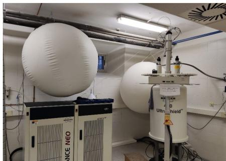
Para el Servicio de líquidos criogénicos del SAI se diseñó un sistema de seguridad destinado al proceso de recuperación de helio en estado gaseoso. Este sistema incorpora un monitor de presión y una válvula automática de alivio, optimizando el uso de los globos portátiles de recuperación de helio y garantizando un funcionamiento seguro y eficiente. SLC (SAI)
