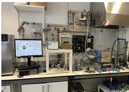
Automatización de una instalación para caracterización electroquímica de celdas de óxido sólido, empleadas para la producción de hidrógeno mediante electrólisis del agua. Estas medidas se llevan a cabo sobre celdas microtubulares controlando distintas variables como temperatura, flujo, presión de gases (hidrógeno, nitrógeno y aire) y humidificación de hidrógeno. Departamento de Ciencia de Materiales y Fluidos. (EINA)
