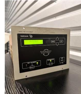
Reparación del módulo electrónico que controla una bomba de sublimación de titanio utilizada en un sistema de vacío ultraalto. Laboratorio de Microscopías Avanzadas (LMA).
