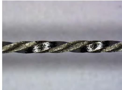
Imagen multifoco obtenida, tras la observación en el microscopio digital Leica DMV6-A, con el software LAS X. Se trata de un inserto de microfluídica para favorecer el proceso de mezclado y fabricado por el grupo de trabajo del Dr. Victor Sebastián Cabeza.
