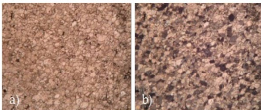
Microfotografías de láminas delgadas realizadas por el servicio para un trabajo sobre el origen de los mármoles de la villa romana de Quinta das Longas (Elvas, Portugal). Tomada de Lapuente et al.2021
