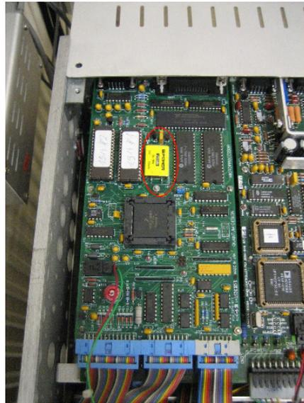
Centro de investigación biomédica de Aragón (CIBA). Se resolvió un problema que impedía poner en funcionamiento una centrífuga Beckman Avanti J-E (mostraba un error S7). Se sustituyeron dos circuitos integrados dañados: una memoria RAM y el reloj de la placa base.
