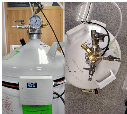
Dewar de nitrógeno líquido con cabezal para control electrónico de presión.
