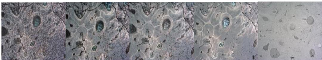
Evolución del pulido metalográfico en una lámina delgada de una sección de hueso fósil.
