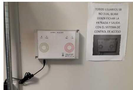
Sistema de registro RFID para usuarios de sala blanca en el INA.
