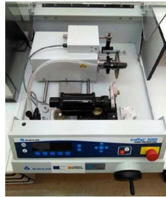
Cortadora metalográfica de precisión comercializada por Buehler.
