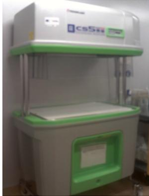
Cabina de cambio con flujo laminar
