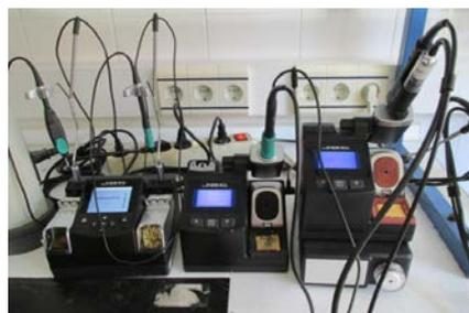
Estaciones de soldadura y desoldadura
