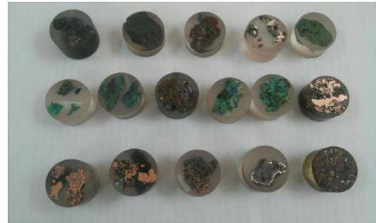
Los trabajos que podemos realizar en el servicio directamente abarcan las preparaciones microscópicas, los pulidos mineralógicos y metalográficos, el molido y la obtención de testigos y el refrentado de dichos testigos para posteriores ensayos de compresión. Además, también está abierto el préstamo a usuarios de algunos de los equipos como pueden ser los de sondeos saca testigos.
