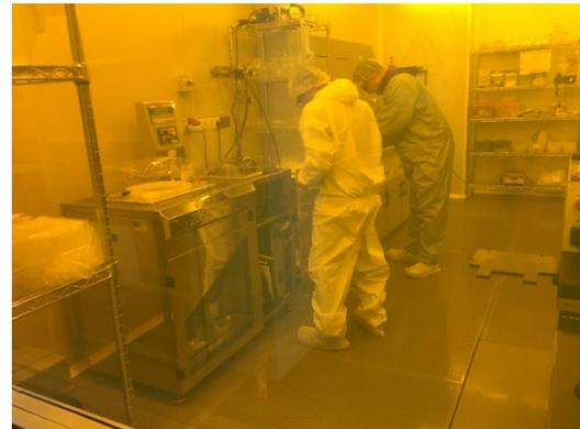
*Sistema de deposición por evaporación mediante un cañón de electrones (Edwards 500). Reparación de la fuente de alto voltaje (5kV, 600mA).*
