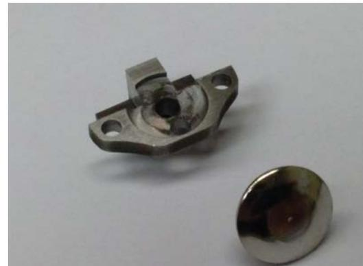
*Ejemplo de una pieza fabricada en el Servicio: evaporador portátil (INA), que permite la evaporación de moléculas “in time” dentro del propio microscopio en condiciones de ultra alto vacío.*
