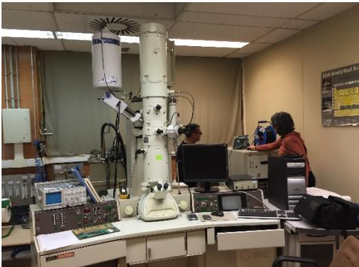
*Microscopio electrónico de transmisión (TEM) JEOL 2000 FX II. Inestabilidades en la alta tensión dificultaban la observación de las muestras e impedía trabajar en alta resolución.*
