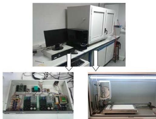
En las imágenes aparece el sistema de control y adquisición desarrollado para una cuba de Langmuir utilizada para deposición de láminas delgadas a presión y temperatura constantes.
