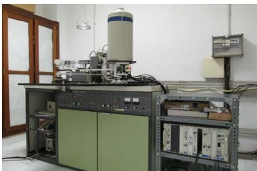
*La difracción de rayos X de monocristal se aplica a muestras cristalinas de productos inorgánicos, orgánicos y organometálicos, siendo la principal técnica para la determinación de su estructura tridimensional a escala atómica. Además, el equipo permite*
