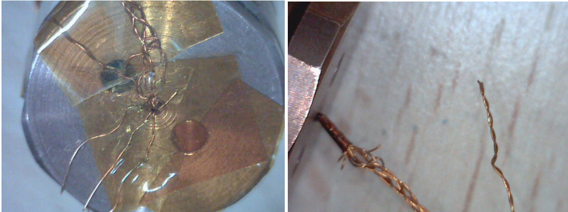
Figura 6. Fotos de los cables de contacto que salen de la celda por la parte superior.
