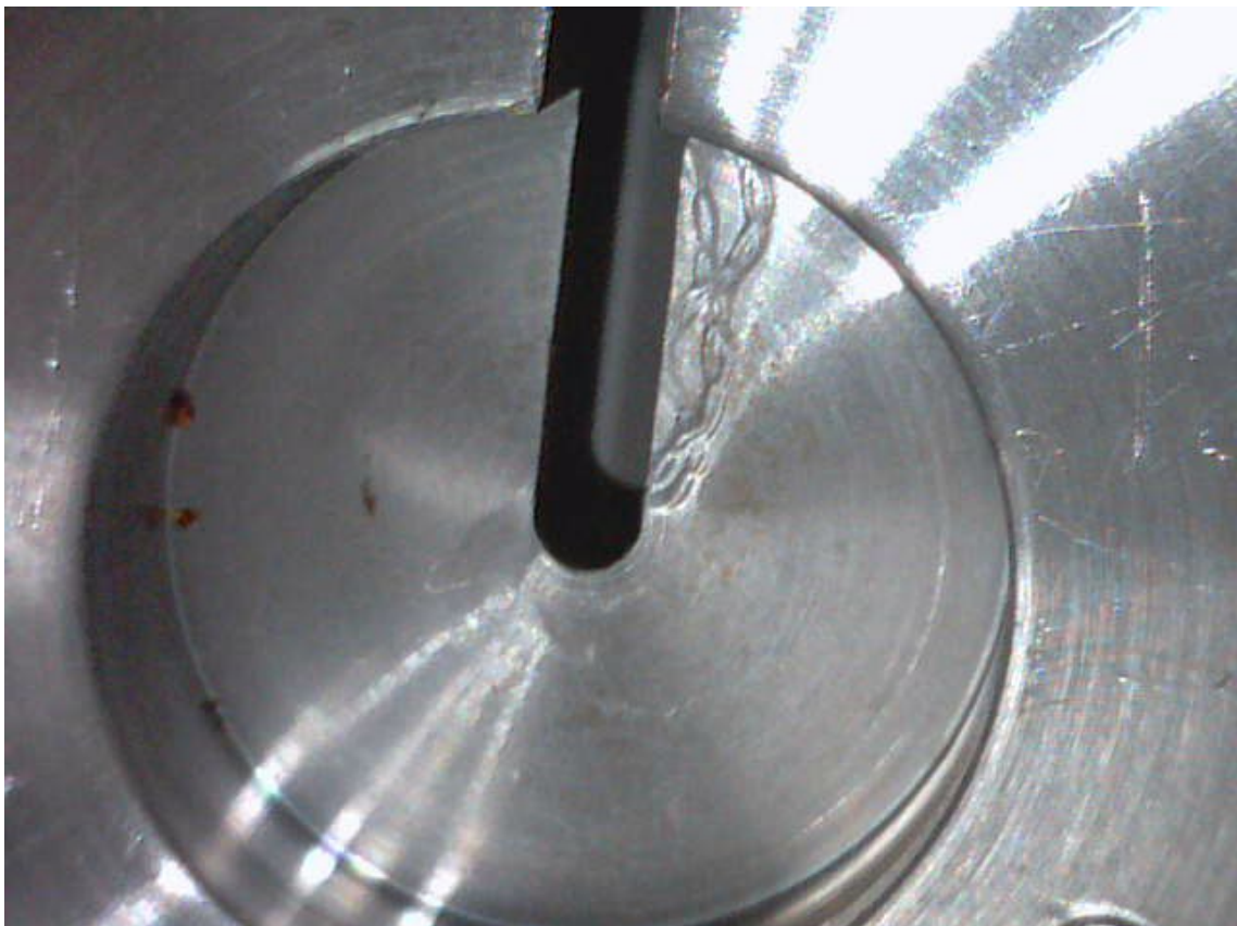
Figura 5. Foto de base del pedestal donde se ve el efecto de aplicar presión cuando los cables no están bien posicionados en el hueco de salida.
