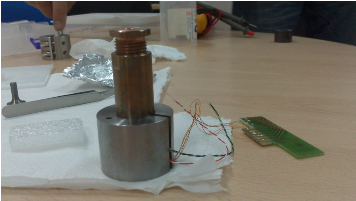
Figura 4. Foto de la celda montada en el pedestal para aplicar P. Los cables salen por la guía.
