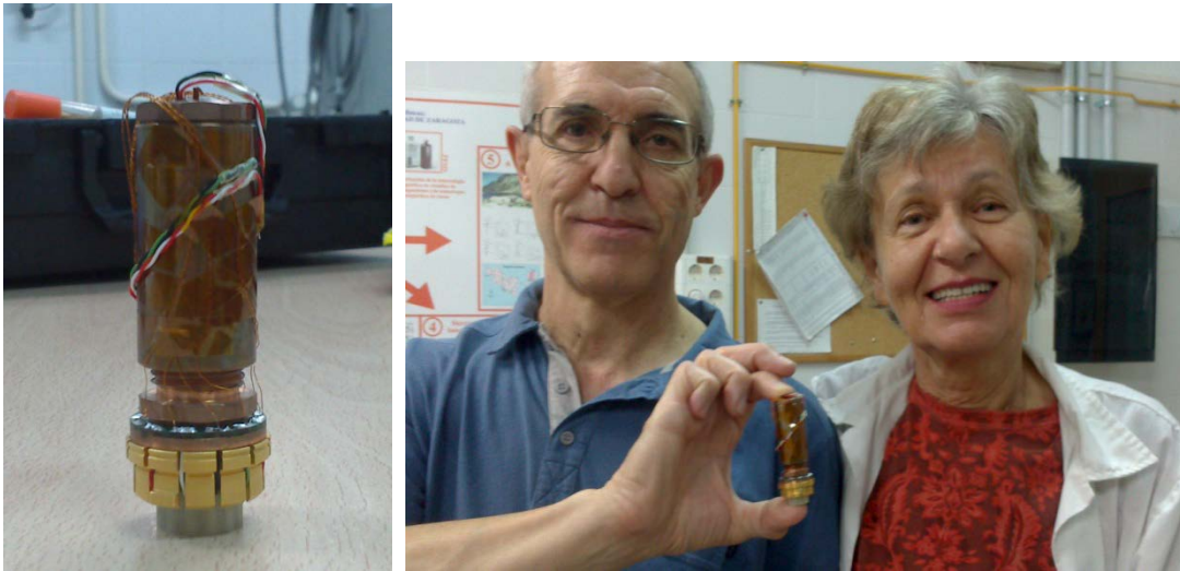
Figura 2. Izquierda: Foto de la celda completamente montada ya en el portamuestras del PPMS. Derecha: Enrique Guerrero y Jolanta Stankiewicz mostrando el resultado del montaje.
