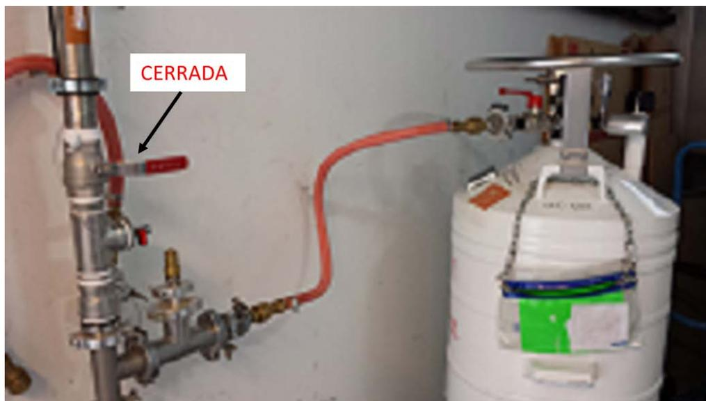
5.1.4. Se abrirá primero la llave de purga de la línea de recuperación y después, ligeramente, la llave de salida de gases del dewar. Se deberá notar que sale gas por la llave de purga de la línea.
